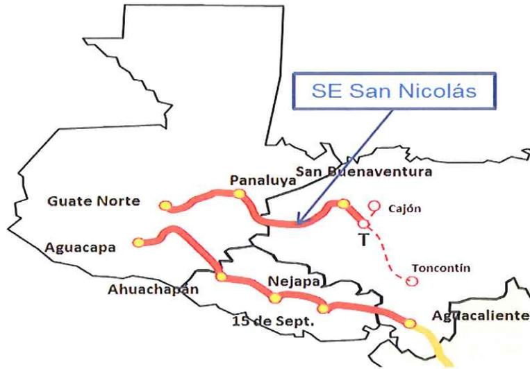
Figura 1: Ubicación de subestación San Nicolás 25 MVA, 230/34.5 kV
